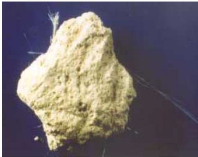
Plâtre du calorifugeage contenant quelques faisceaux de fibres d'amiante
