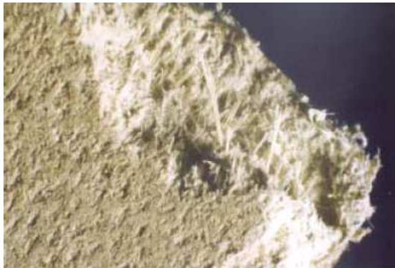
Plaque fibreuse légère avec 40 % d'amiante
