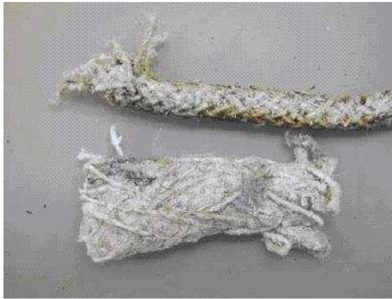
Cordon d'amiante tissé utilisé comme joint de protection de feu
