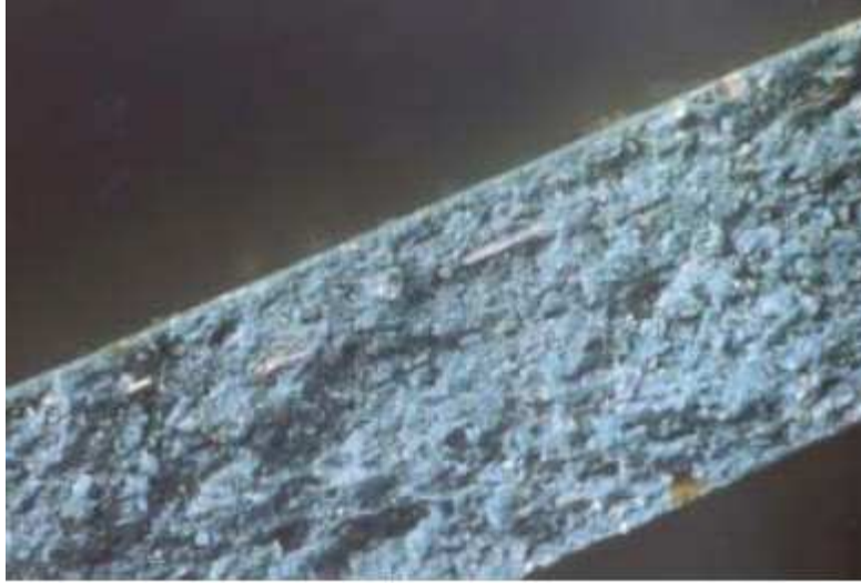
Tranche d'une dalle de revêtement de sol unicouche contenant de rares faisceaux de fibres d'amiante blancs
