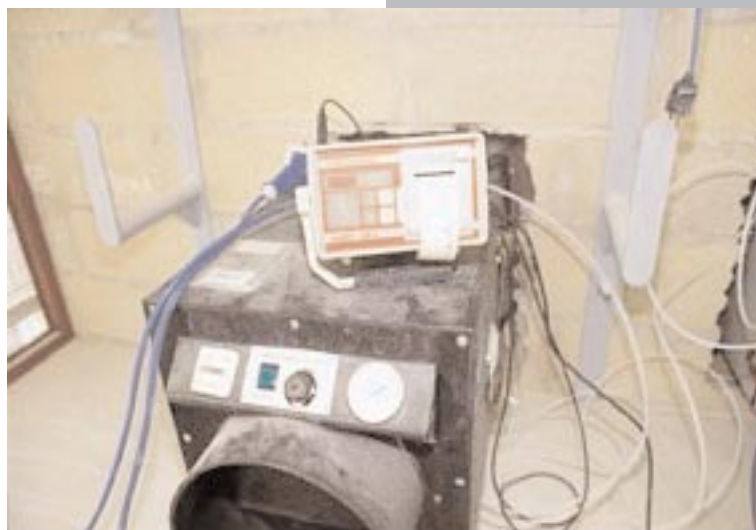
Enregistrement en continu de la dépression.
